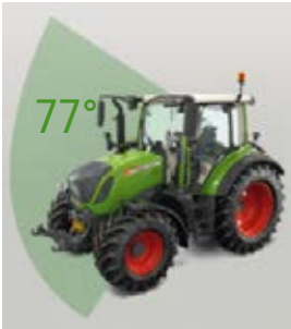
Parabrisas panorámico con visión de 77° para una visibilidad completa hacia arriba y de los pasos de rueda.
