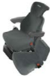
■ El asiento confort incorpora suspensión neumática y ajuste sencillo del reposabrazos.
