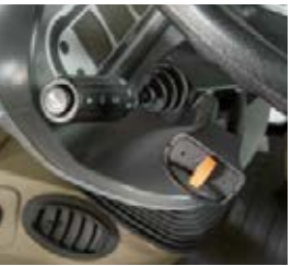
Sumamente práctico: el reinicio de los intermitentes se controla mediante 3 factores: ángulo de giro, tiempo y velocidad.
