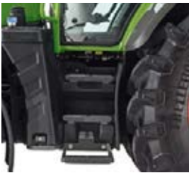
■ Los escalones están protegidos contra la entrada de suciedad por el lateral. La amplitud de estos escalones y la disposición óptima de la barandilla permiten subir y bajar con total seguridad. La manilla de la puerta es fácilmente accesible desde el suelo.
