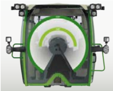
Visibilidad completa con el alcance de 300° del limpiaparabrisas: el exclusivo limpiaparabrisas abarca todo su campo de visión, incluyendo los pasos de rueda.
