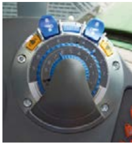
Manejo intuitivo con el compacto módulo de control (EPC) y el control de la TdF.
