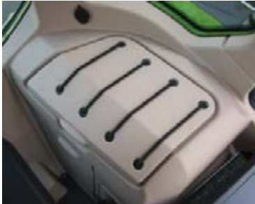
Los alimentos y bebidas se mantienen frescos en el compartimiento de almacenamiento refrigerado. El compartimiento situado detrás del asiento del pasajero puede abrirse con una mano.
