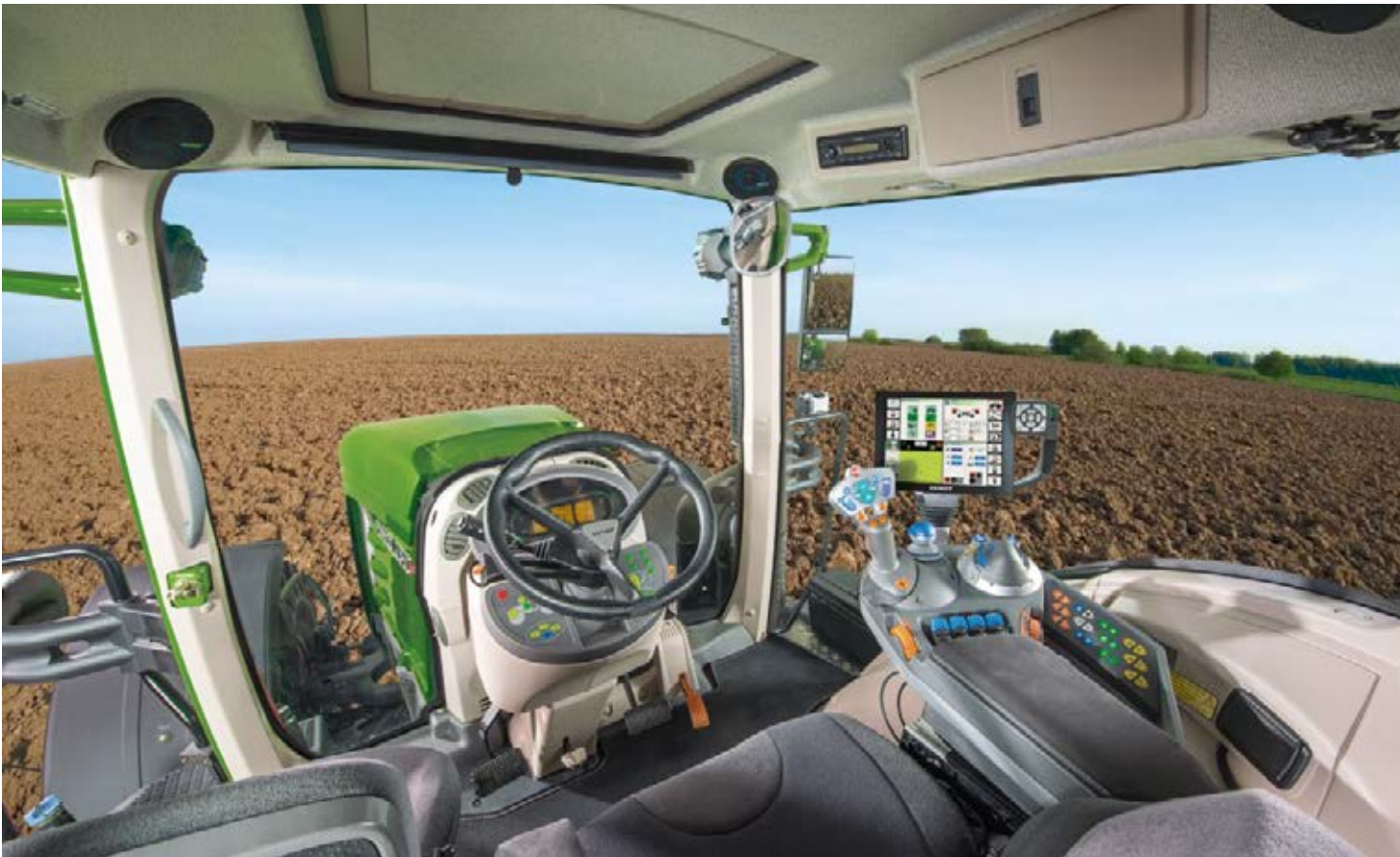
El limpiaparabrisas de 300° amplía su campo de visión y mantiene limpia la luneta incluso en las condiciones más adversas, por lo que siempre tendrá una visibilidad perfecta de todo el frontal del tractor y de los pasos de rueda.
