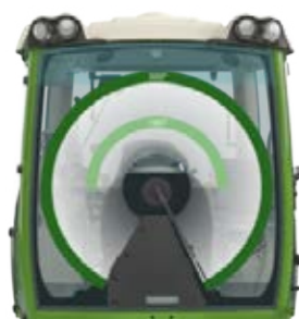
El limpiaparabrisas de 300° amplía su campo de visión y mantiene limpia la luneta incluso en las condiciones más adversas, por lo que siempre tendrá una visibilidad perfecta de todo el frontal del tractor y de los pasos de rueda.
