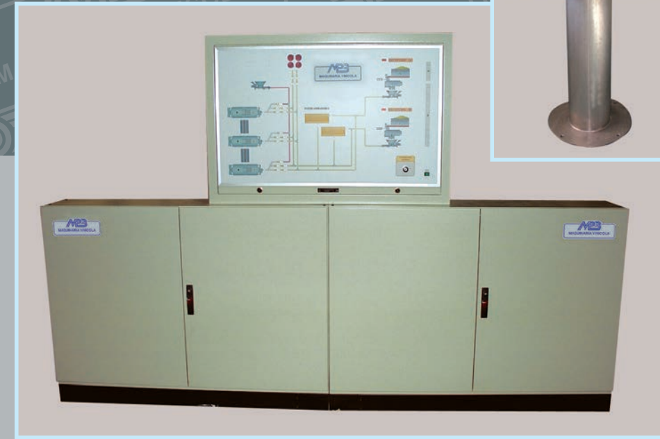
CUADROS SINOPTICOS PARA EL CONTROL DE MAQUINARIA DE RECEPCION, PRENSADO Y DISTRIBUCION DE VENDIMIA DE FORMA AUTOMATIZADA
