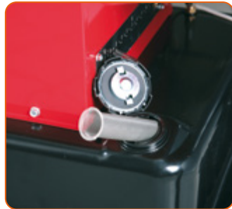
Filtro de llenado para el depósito de combustible. Cod.: 02AC556
