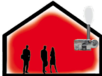
CALOR LIMPIO, CON SALIDA DE HUMOS AL EXTERIOR
