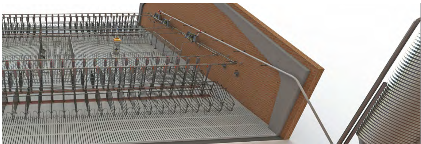
Sistema de reparto de pienso combinado, mediante transporte por espiral desde el silo a los circuitos de cadena.
