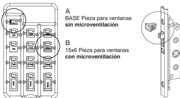
Se debe montar un cerradero en el marco que haga de sufridera para el activador del sistema anti-falsa maniobra de bloqueo del multipunto. Es necesario realizar un recorte en el PVC a la distancia indicada del eje de la manilla y colocar el cerradero en la posición indicada en las imágenes fijándolo con dos tornillos.
