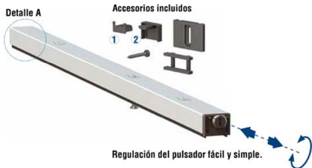
Detalle A: Colocación Tapa Final (incluida en la guarnición)
