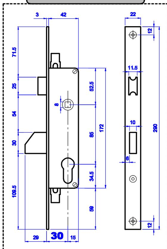
*No se deben fabricar puertas con cerradura con una medida de hoja inferior a 600 mm. pues la manilla golpearía en el perfil de acople.*
