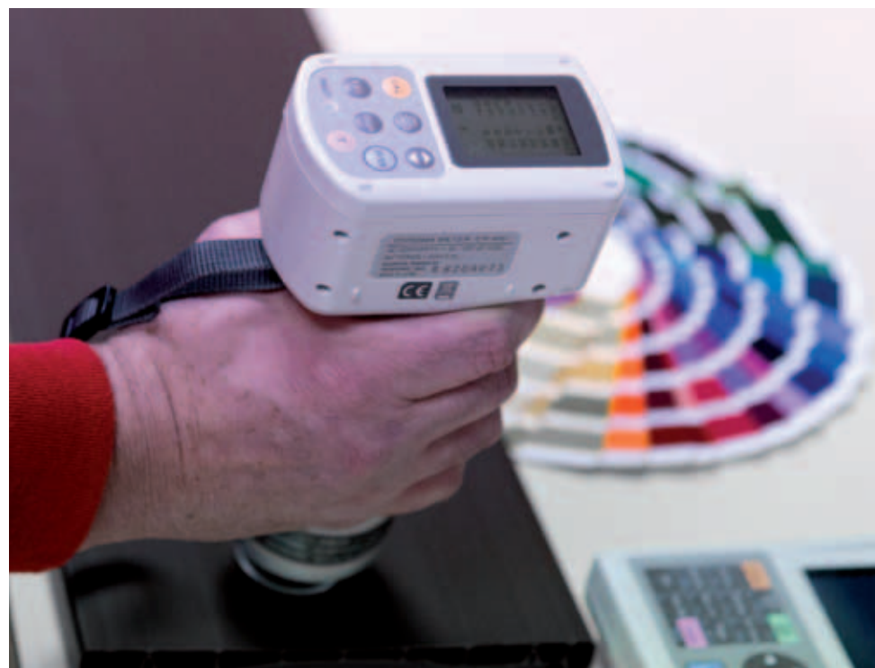
Determinación de la colorimetría en perfil de cajón de PVC
