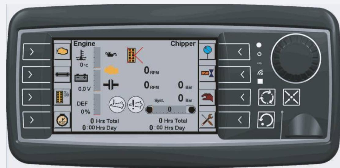
3 Opcionalmente, usted puede añadir el Europe Controller con PLC. La revolucionaria pantalla PLC muestra todo tipo de información relevante de la máquina. El Europe Controller en combinación con válvulas proporcionales dan un vario chip: Usted podrá cambiar el tamaño del chip del G10 a G50 con tan sólo presionar un botón.
