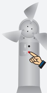
c. Pulse la tecla de programación ① en el emisor SWC441-II dentro del plazo del modo de programación hasta que se produzca una confirmación ② ("vaivén" de la parte accionada).
