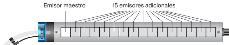
El emisor maestro se programa en el receptor a través de la tecla de programación de radio/el interruptor de radio, o bien por medio de un Power ON. Todos los demás emisores se programan en el receptor con la ayuda del emisor maestro. Programando un emisor en varios automatismos puede configurarse así un emisor de grupo o central.
