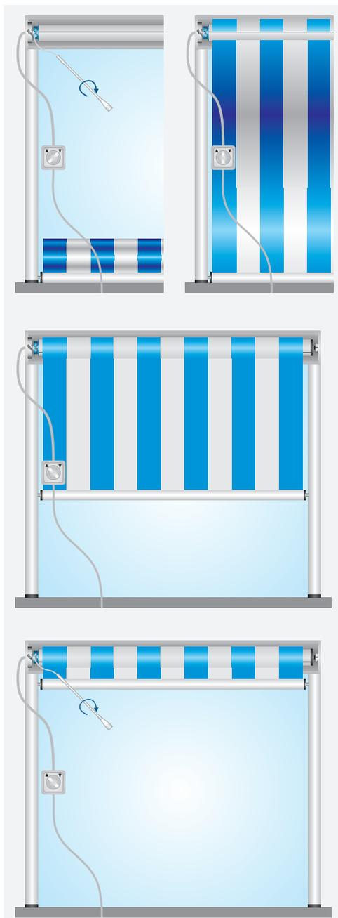
Desconecte el sentido de entrada. Gire el ajustador para la posición final de salida entre 3 y 10 vueltas en sentido "-" con el dispositivo de ajuste flexible (según el número de vueltas del paño sobre el eje con la parte accionada desplegada).
