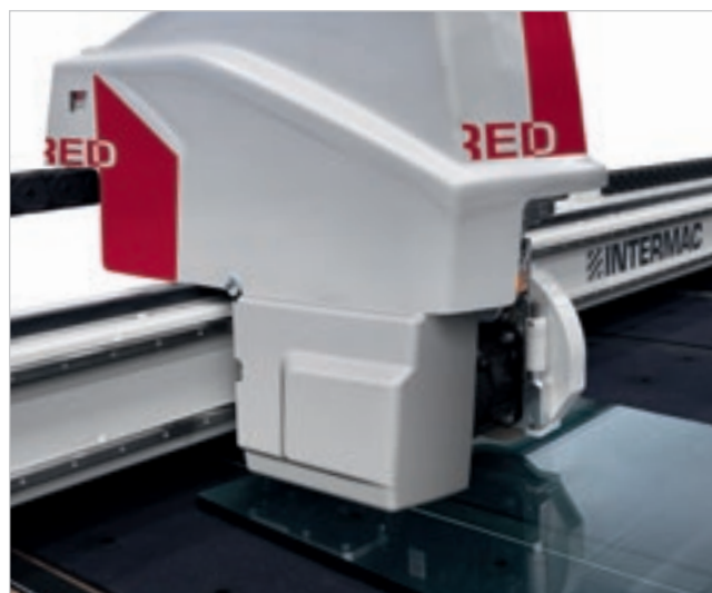
Los conos portarruedas permiten cambiar las herramientas de corte automáticamente.
