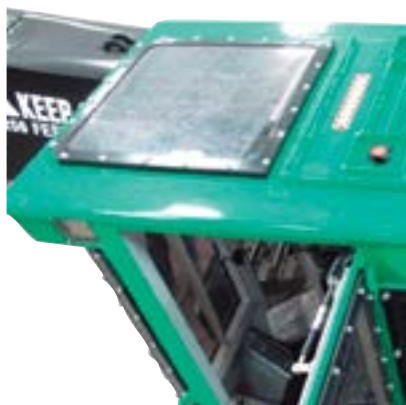
Cabina con techo cubierto y salida de seguridad. Faros LED. Posible apertura de la ventana para ventilar
