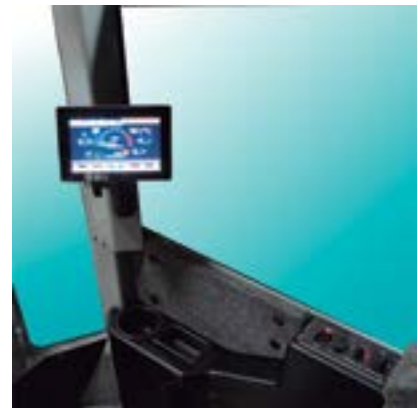
Pantalla de control táctil. Muchas tomas de 12V, compartimento para el móvil.
