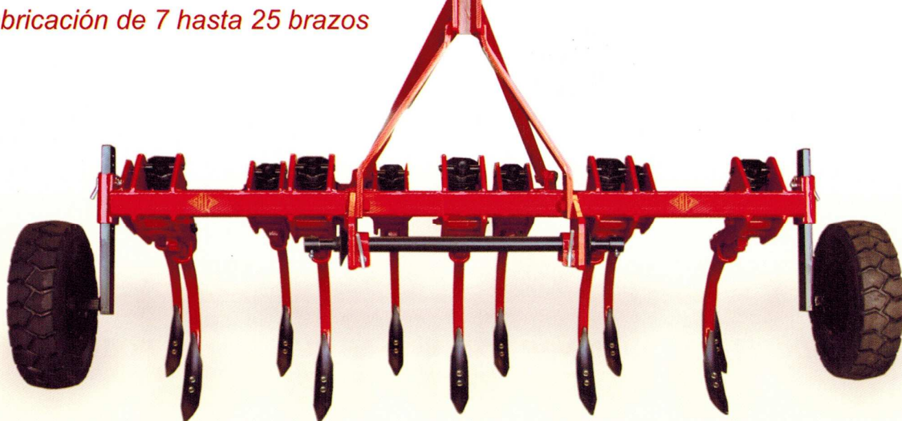
Detalle del brazo 40x40 con sistema de recuperación por muelle
