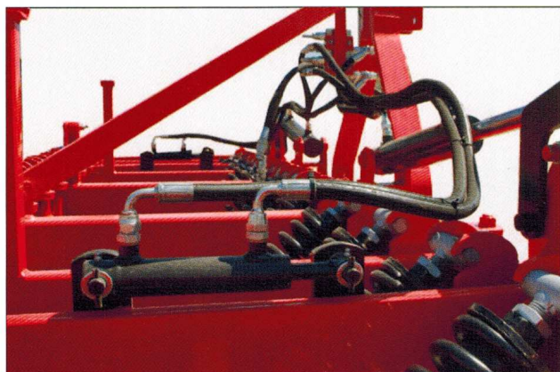
Detalle cierre hidráulico
