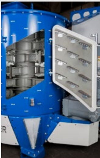
Puerta de mantenimiento con cierre de seguridad
