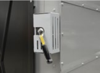
Cabrestante para el ajuste de la chapa de guía
