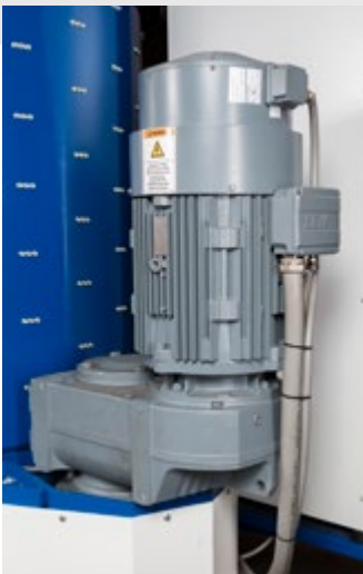
Motorreductor de calidad, de SEW
