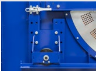
Ajuste de la altura del tambor
