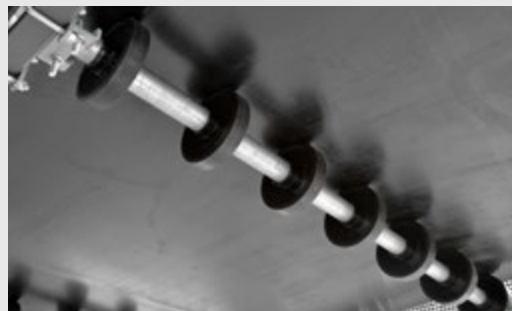
La parte inferior de la cinta se apoya en rodillos (en la imagen, ejecución especial a prueba de enredo)
