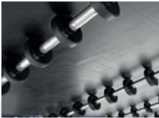
Recorrido inferior, transportado por los rodillos inferiores de la cinta
