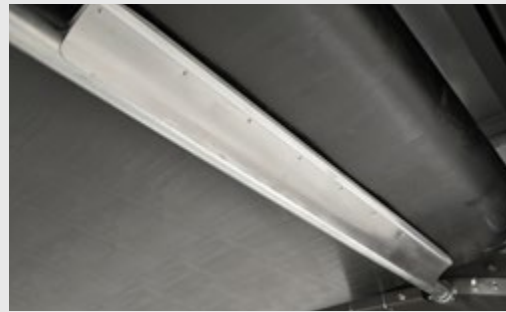
Los rascadores mantienen limpia la superficie de la cinta
