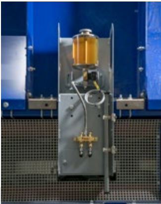
Engrasador de cadena Controlado por una válvula de 24 V
