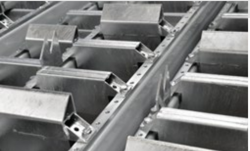
Particularidades Ajuste especial de los pádeles para mejorar la separación de cartones
