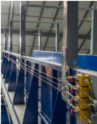
Plataforma de reconocimiento y portales de cables de desgarre
