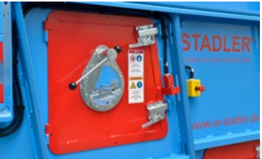
Puerta de mantenimiento Acceso sencillo al interior del separador, para realizar trabajos de mantenimiento o limpieza
