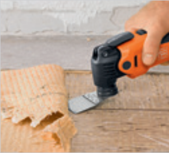
Con la espátula rígida podrás eliminar rápidamente, con facilidad y sin dejar restos moquetas y restos de adhesivo.
