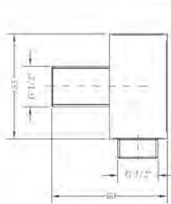
Ref.: 1679 04 Toma ducha mural cuadrada Square wall flexible connector Box: 1 | Carton: 96 | Pallet: 2304
