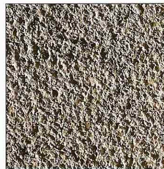
Superficie "bocciardata" "Bushhammered" surface "Kraushammer-Effekt" Oberflächen Surface bouchardée
