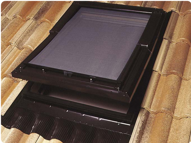
Ventana para tejado tipo 439, fabricada en madera de pino nórdico de primera calidad, completamente barnizada en todas sus caras. Cristales Thermoplus de 24 mm (4, 16, 4). Apertura pivotante.
