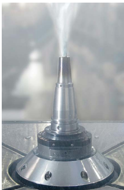
Refrigerante dirigido hacia la punta de la herramienta de corte 18.000 rpm. Líquido refrigerante para o topo da ferramenta de corte a 18.000 RPM.
