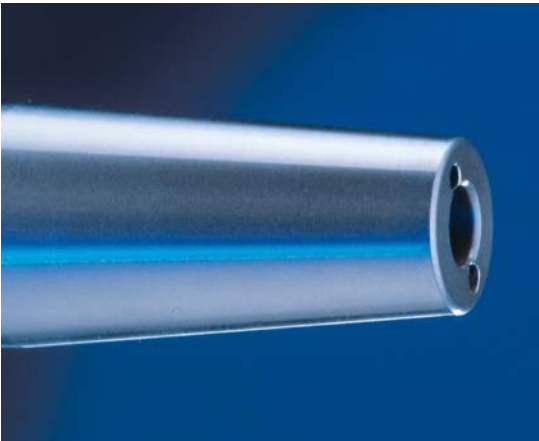
Taladro para refrigeración optimizado: sistema Cool Jet HAIMER con orificios oblicuos Furos de líquido refrigerante voltados para o centro Cool Jet da HAIMER
