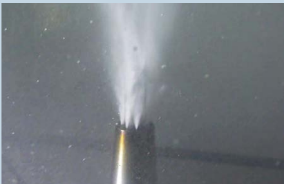
Cool Flash – Refrigeración efectiva en el filo de corte Cool Flash – Refrigeração ótima na aresta de corte
