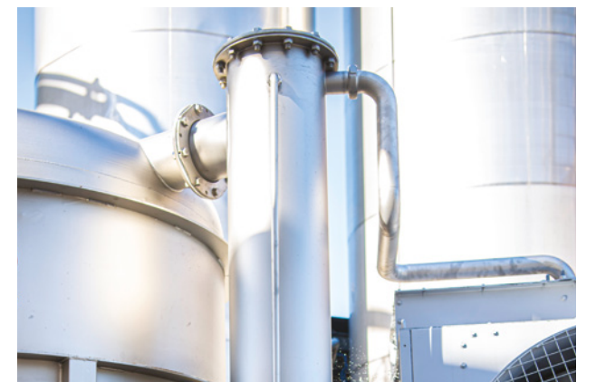
Inyección de la uva calentada en el tanque de expansión
