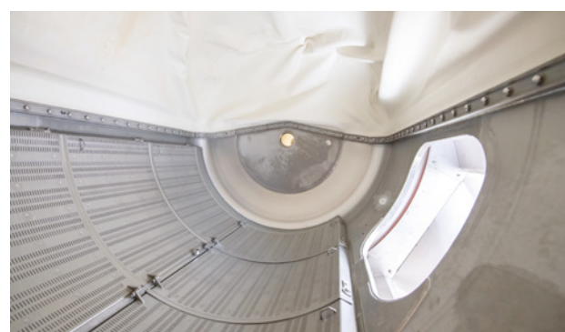
SPC²: interior de la prensa sin recovecos
