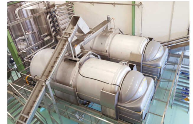
Sistema de sangrado y alimentación de los orujos fermentados en las prensas
