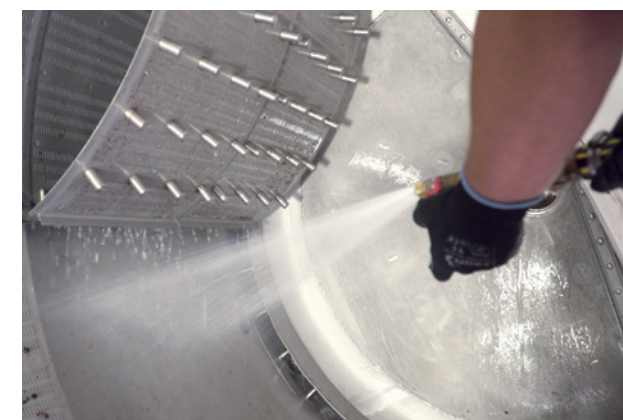
SPC: rejillas de drenaje Fast Press giratorias
