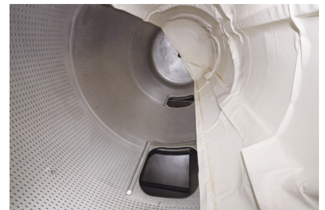
Membrana y hélices de recentrado de orujos
