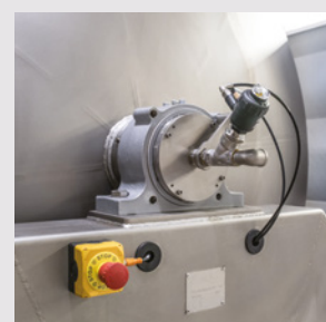
Eliminación de orujos con tornillo sinfín
