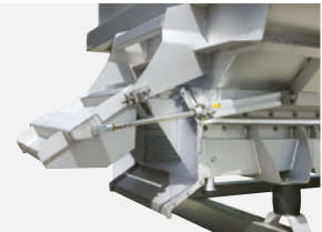
Puerta estanca que se acciona con cilindros neumáticos
