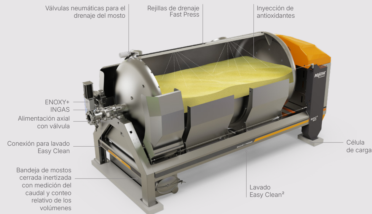
Prensa SMART PRESS de cuba cerrada SPC² 80: vista en sección
