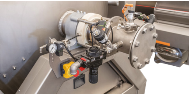
Inyección de gas neutro: Ingas, gas durante removido
