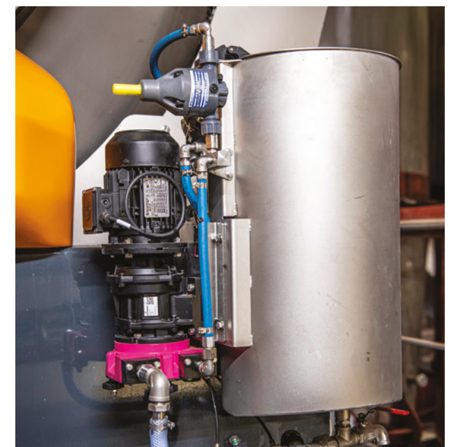
Sistema de inyección de insumo enológico líquido
