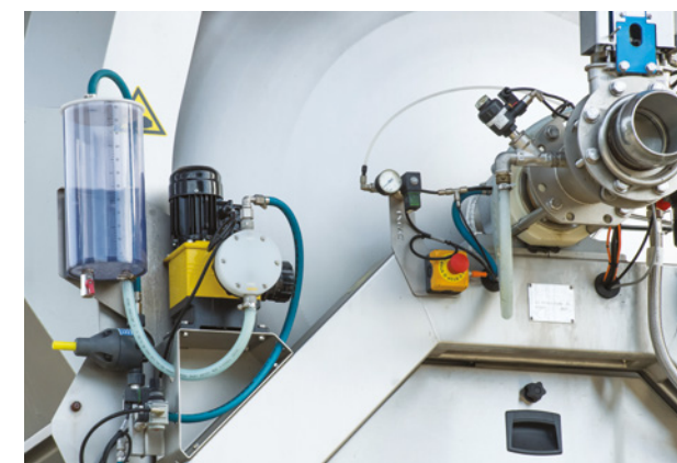
Conexión de gas neutro al nivel de la entrada axial
