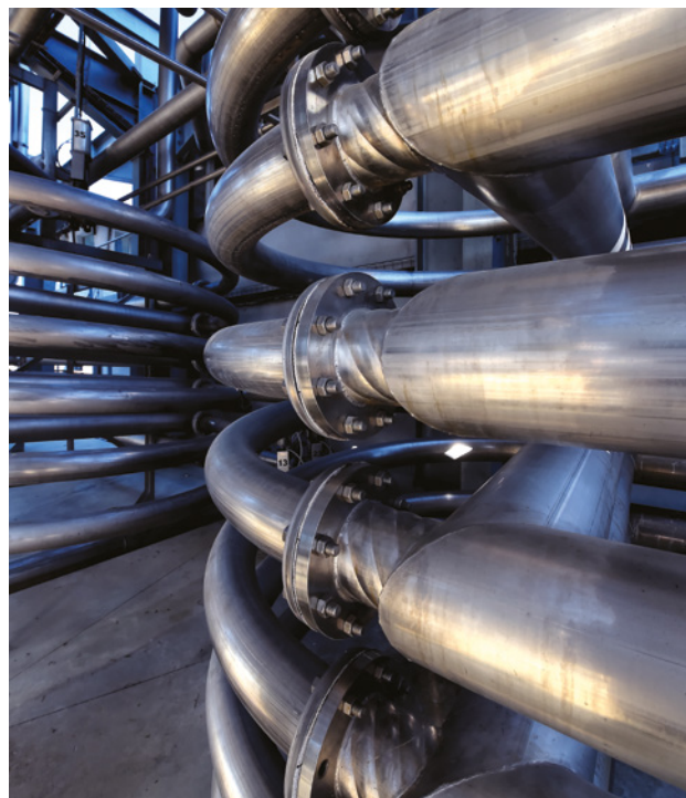
Intercambiadores para vino
