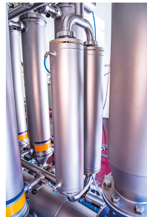
Sistema de Back Wash (retrolavado)
