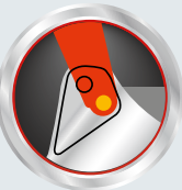
11,5 M POSICIÓN INFERIOR DEL EJE PASANTE PARA PLUMA MAYOR ALTURA DE AGARRE
