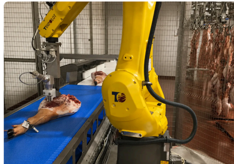
Robot para medir el pH en jamones y canales
