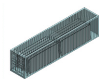
Depósito W-Tank® de 36 Placas Salamanca, H=5m, D=25m y 2.534 m³ de capacidad en un contenedor de 40 pies.
