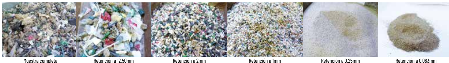
Ensayo granulométrico de una muestra procedente de un equipo DA Defender® instalado en una fábrica de plásticos.
