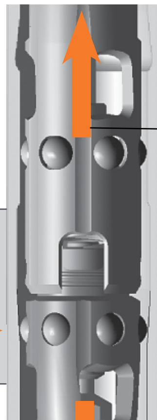
Imagen 2 - Retracción del wireline
