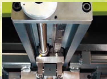
Sistema de transmisión del tope posterior
