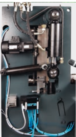
Sistema accionamiento trancha de corte
