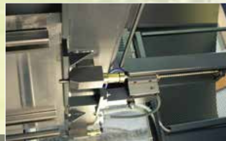
Dedos de apoyo de la chapa en el tope posterior
