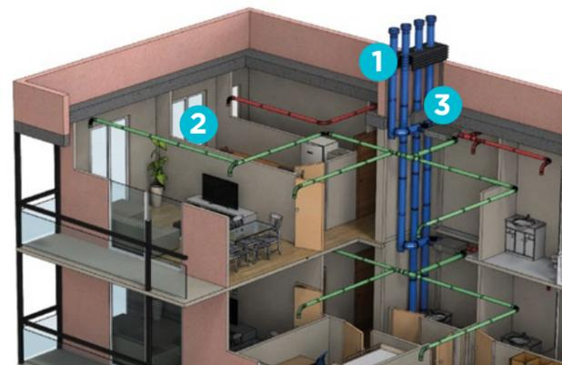
1. Conducto concéntrico de dos paredes **SVC-D**.
