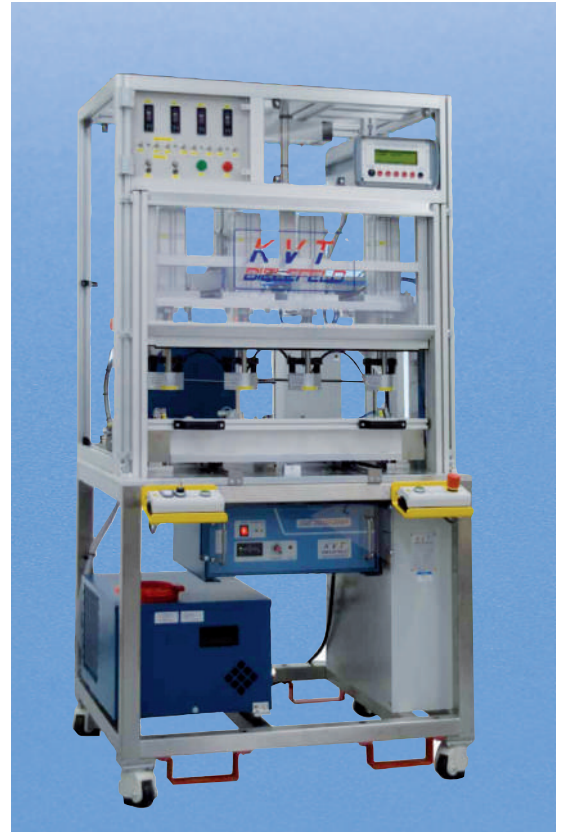
Máquina para la colocación por calor (ERW) de cuatro insertos en un sistema de arranque de automóvil.
