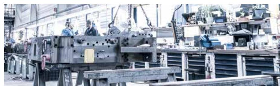
Los moldes a presión y las matrices de forja se emplean para fabricar en serie componentes metálicos, generalmente para motores.
