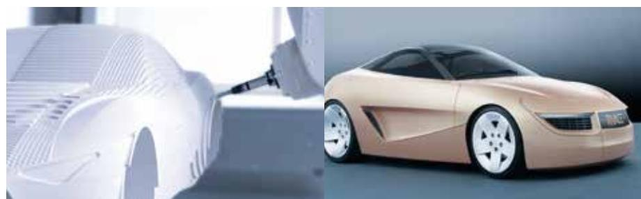
Los clientes de Tebis en el ámbito de la construcción de carrocerías fabrican modelos de control de datos y de cubing, y prototipos de vehículos completos.
