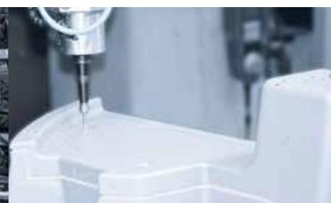
Los moldes térmicos son necesarios para la producción en serie de piezas de plástico. Tebis se utiliza a menudo para el fresado de corte en bordes y secciones.
