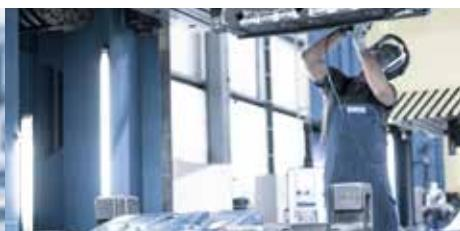
En el montaje de los troqueles, el troquelista ensambla las piezas adquiridas y las fabricadas a nivel interno utilizando Tebis Viewer y nuestro software MES ProLeiS. Durante la puesta a punto se utiliza la ingeniería inversa de Tebis después de realizar un exhaustivo trabajo de amolado manual. Las áreas de modificación digitalizadas se transfieren al juego de herramientas CAD.
