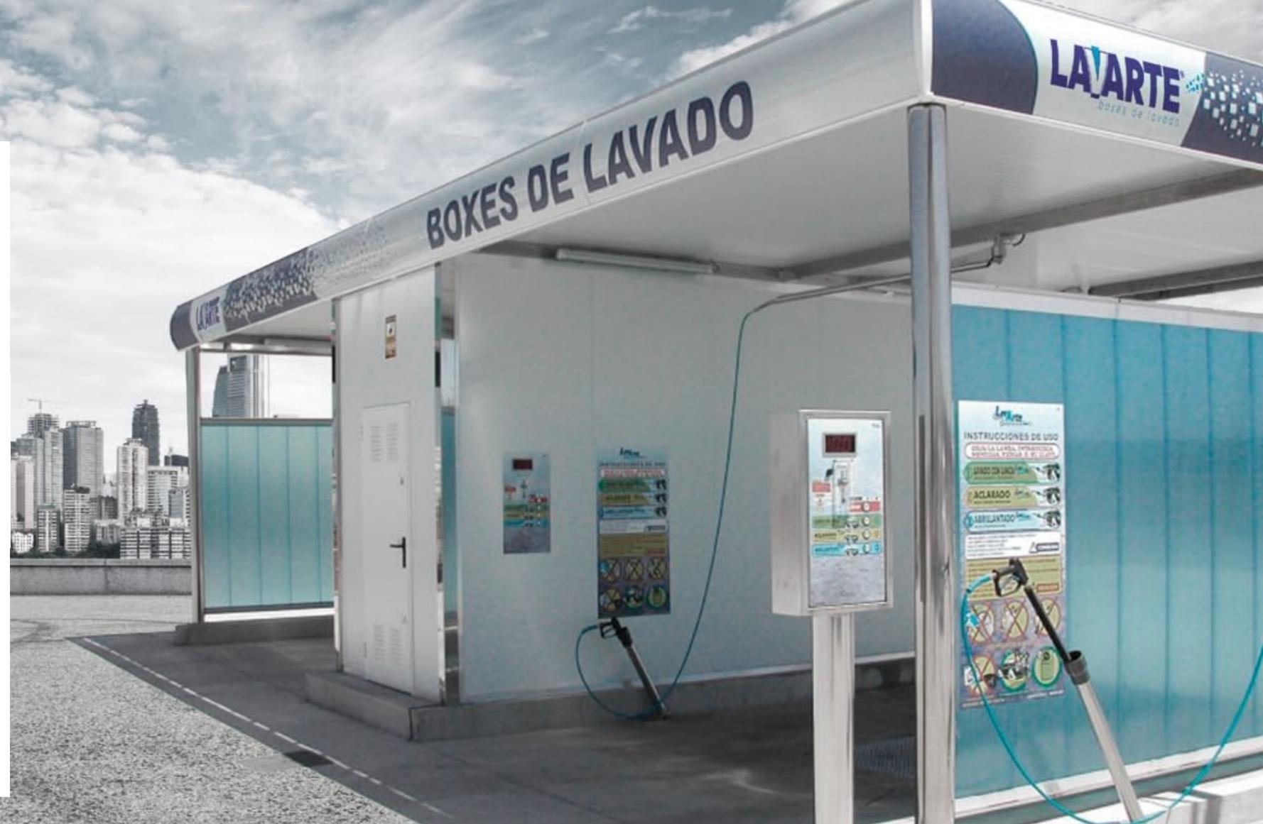
EL CERRAMIENTO QUADRO ES UNA EXSTRUCTURA METALICA DISEÑADA PARA CUBRIR ZONAS DE LAVADO DE VEHICULOS EN AUTOSERVICIO. ESTA COMPUESTO POR MODULOS, TOTALMENTE ATORNILLADOS COMO UN MECANO LO QUE PERMITE SU MONTAJE/DESMONTAJE TANTAS VECES COMO SEA NECESARIO.
