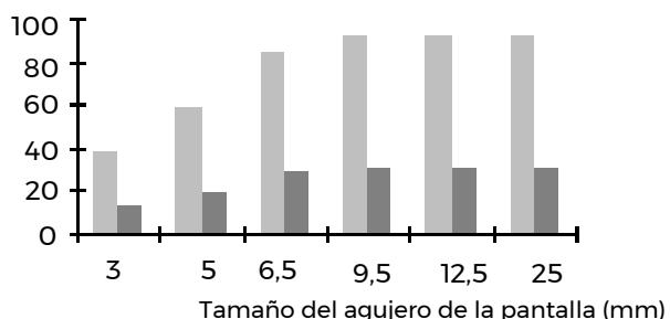
La capacidad depende del tipo de material y el flujo de aire a través del granulador.
