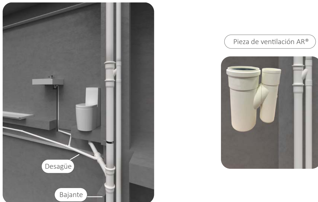
Figura 7. Esquema ventilación secundaria
