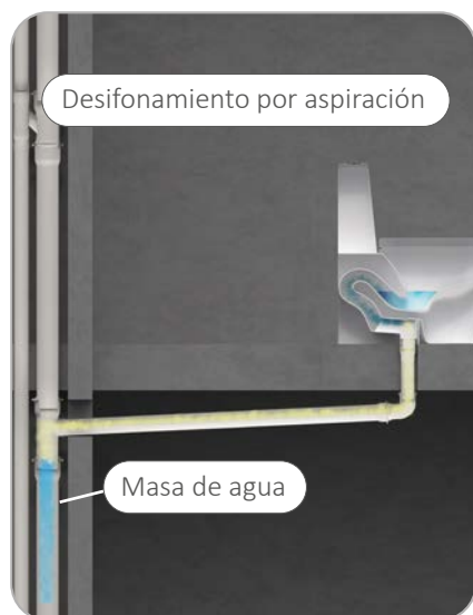
Figura 3. Esquema de un sistema de evacuación que puede producir sifonamiento por aspiración
