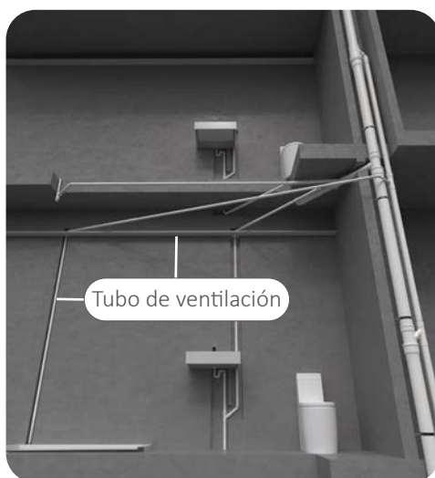
Figura 9. Esquema ventilación terciaria
