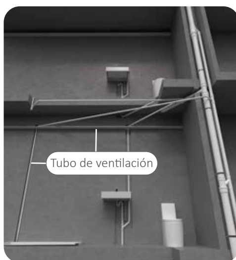
Figura 9. Esquema ventilación terciaria
