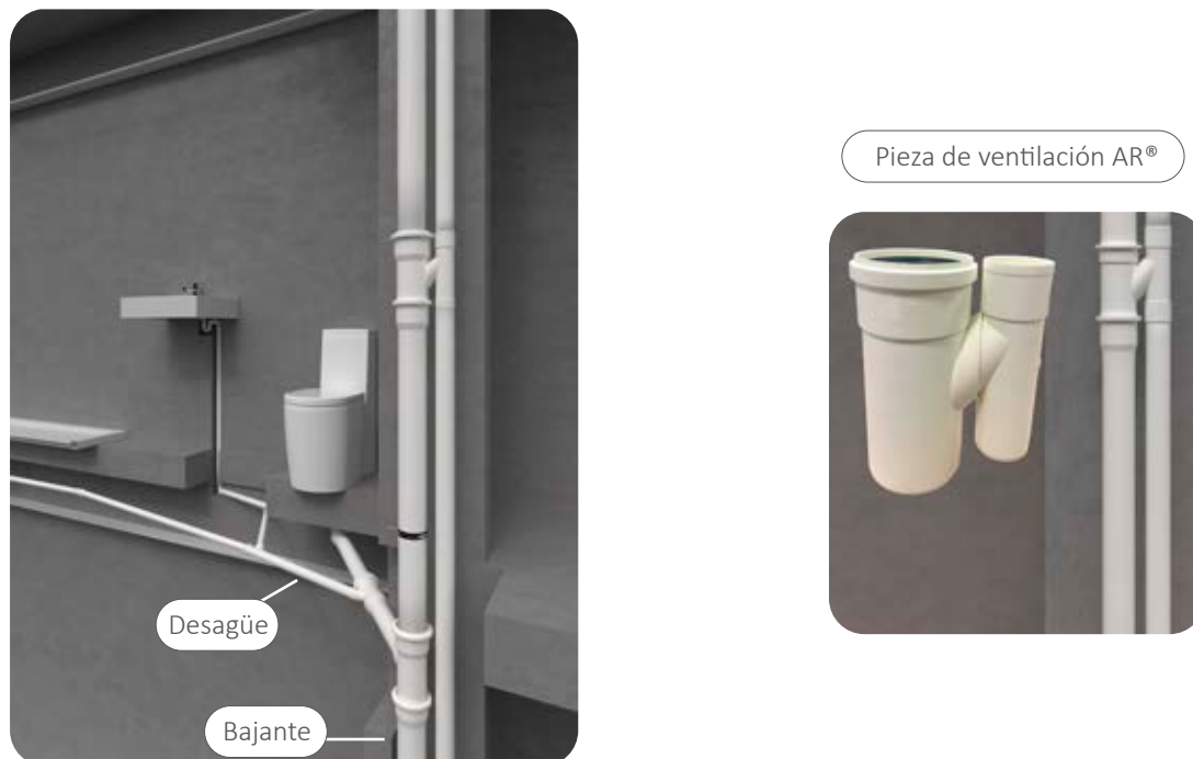
Figura 7. Esquema ventilación secundaria
