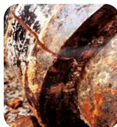
Efectos de la corrosión exterior e interior en tuberías
