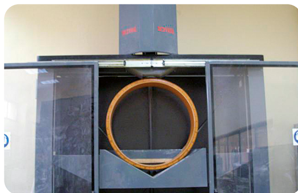
Ensayo de rigidez de un tubo flexible
