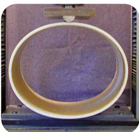
La flexibilidad de las tuberías plásticas es importante para absorber desplazamientos del terreno
