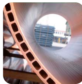
En las tuberías plásticas el coeficiente de rozamiento interno es mínimo
