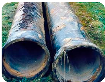
Tuberías que han sufrido ataques por corrosión electroquímica
