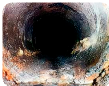
Tuberías que han sufrido ataques por corrosión electroquímica
