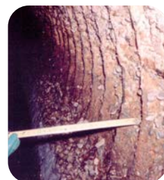
Efectos de la corrosión exterior e interior en tuberías
