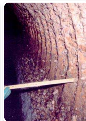
EFFECTOS DE LA CORROSIÓN EXTERIOR E INTERIOR EN TUBERÍAS.
