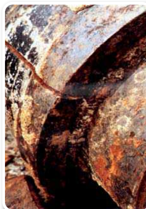
EFFECTOS DE LA CORROSIÓN EXTERIOR E INTERIOR EN TUBERÍAS.
