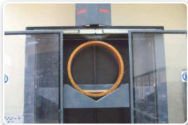
ENSAYO DE RIGIDEZ DE UN TUBO FLEXIBLE.
