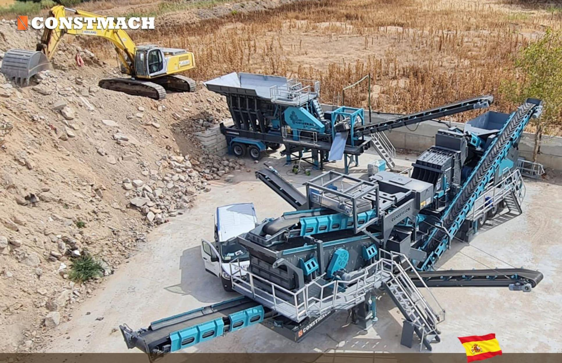
**JS - 2 / MOBILE CRUSHING AND SCREENING PLANT**
