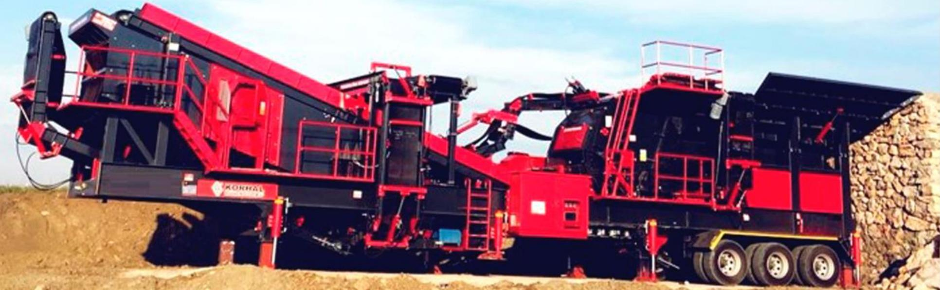
Las plantas de trituración móviles PI series de **CONSTMACH** son la mejor solución para triturar rocas de grandes dimensiones de piedra caliza. Su diseño sobre chasis móvil le permite un montaje y puesta en funcionamiento mucho más económica que una planta fija. Esta planta es ideal para sustituir una machacadora de mandíbulas en su aplicación con piedra de bajo grado de abrasividad, mejorando el ratio de reducción considerablemente.
