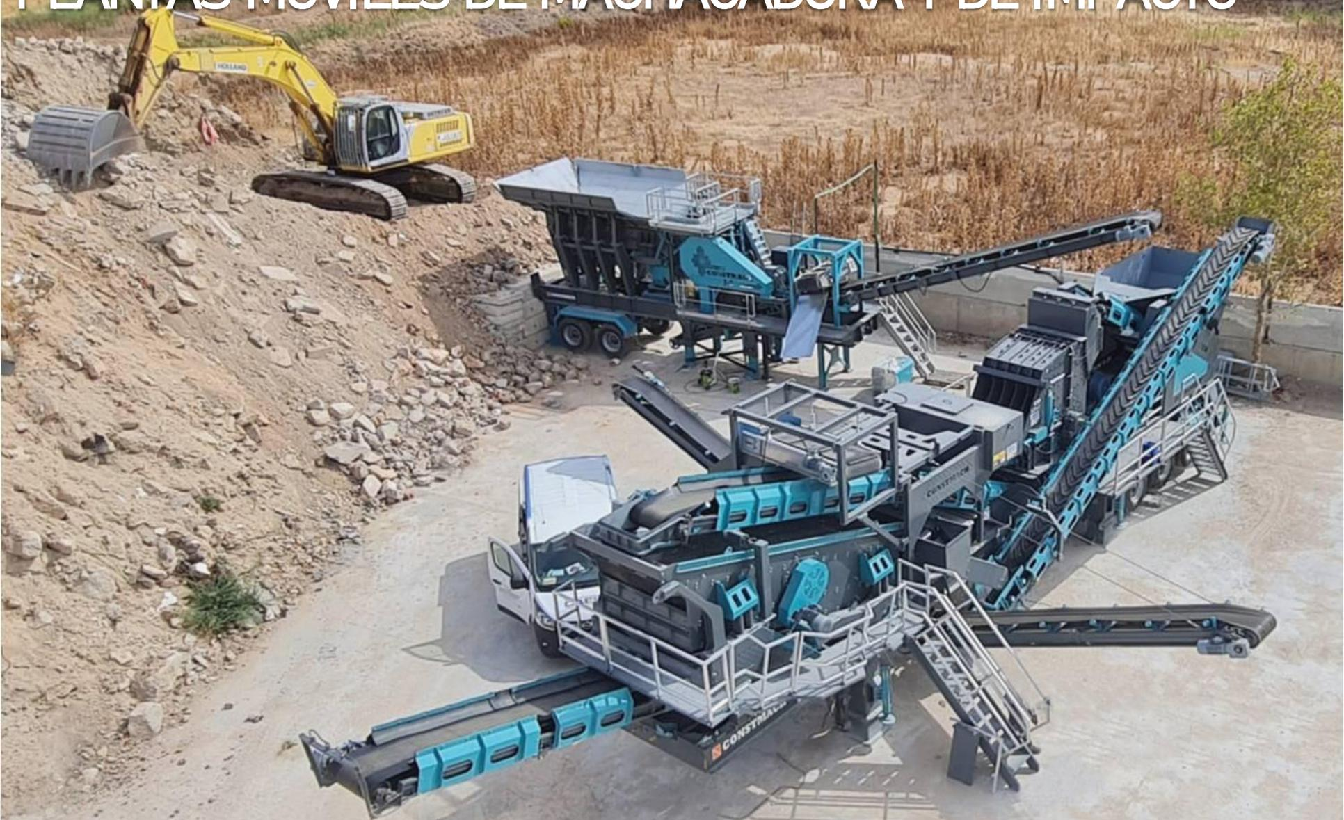
Las plantas de trituración móviles de machacadora de mandíbulas y trituradora de impacto de CONSTMACH se utilizan para triturar una amplia gama de rocas, desde piedra caliza hasta basalto. La presencia de una machacadora de mandíbulas primaria permite triturar rocas grandes y duras. Por otro lado, gracias a la trituradora de impacto secundario, es posible producir una buena forma cúbica de materiales finales de 0 a 60 mm según las necesidades del cliente.
