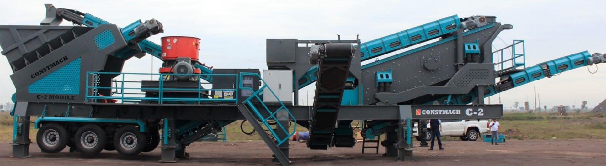
**C-2 / MOBILE CRUSHING AND SCREENING PLANT**
