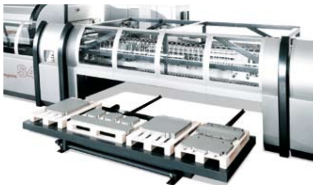
Desapilador universal PD Conexión de la S4Xe para la carga de formatos de chapa. La extracción del formato se realiza con las ventosas fijas que levantan el lado corto del formato, mientras un transportador de cepillos alza el formato y lo traslada a la S4Xe.
