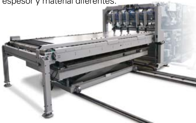
Desapilador universal PD Conexión de la S4Xe para la carga de formatos de chapa. La extracción del formato se realiza con las ventosas fijas que levantan el lado corto del formato, mientras un transportador de cepillos alza el formato y lo traslada a la S4Xe.
