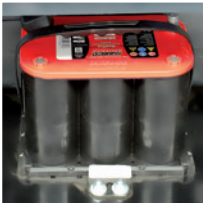
07. Baterías sin mantenimiento
