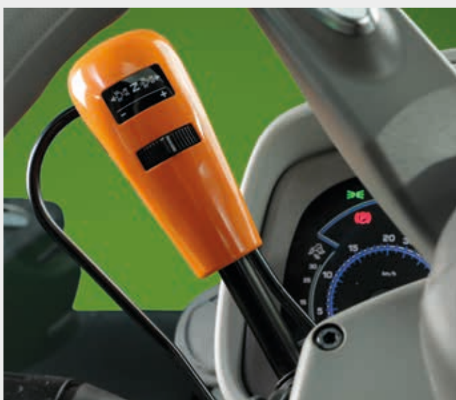
↑ Inversor hidráulico regulable (Sense Clutch) con cinco niveles de ajuste.
