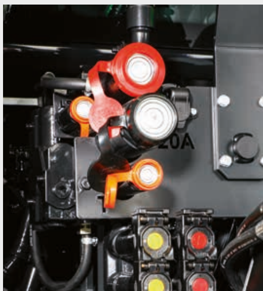
↑ Power Beyond con acopladores de cara plana.
