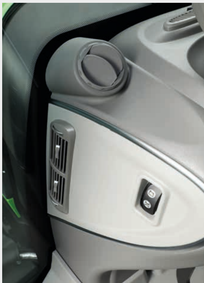
Salidas de aire adicionales e interruptor principal de la batería situados estratégicamente en la cabina.
