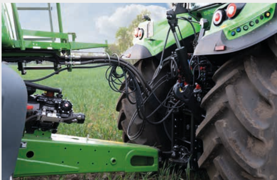
↑ Enganche trasero con posición de transporte para reducir las interferencias con los implementos o remolques en las curvas.
