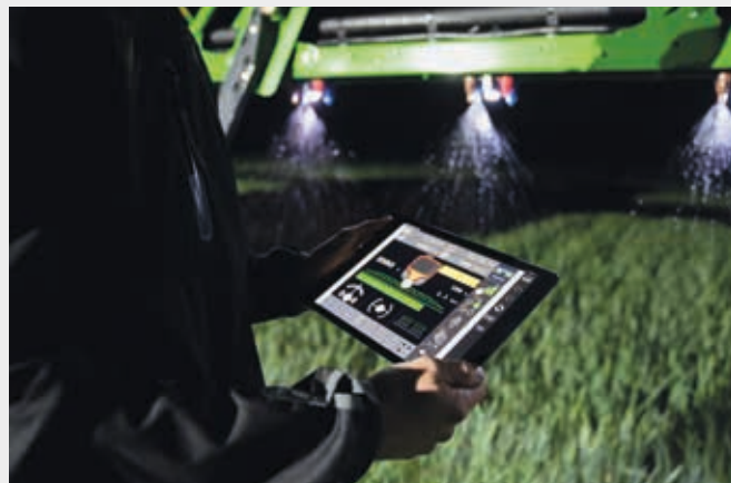
↑ Función XTEND con tablet, control de implementos mediante ISOBUS UT estando fuera de la cabina.
