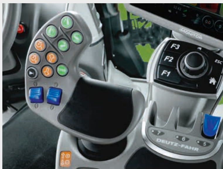
↑ Joystick MaxCom. Diseño ergonómico con control para el elevador delantero y trasero, gestión de cabeceras y dos distribuidores hidráulicos proporcionales.
