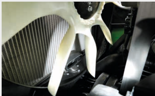
Ventilador electrónico (eVisco) con sistema de prelimpieza del filtro del aire por aspiración.
