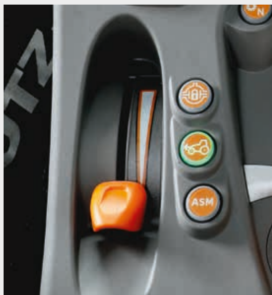
⬆ Acelerador de mano independiente y activación electrohidráulica del bloqueo del diferencial, tracción a las cuatro ruedas y función automática ASM.
