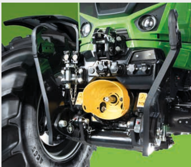
⬆ Elevador delantero con capacidad de elevación de 5.450 kg y TDF delantera DualSpeed.
