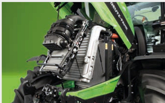
Sistema de refrigeración en aluminio con palanca de acceso, accionable con una mano, y filtro de aire Powercore.
