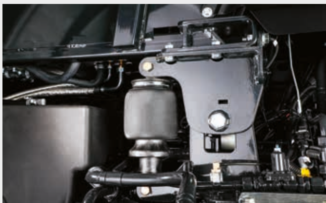
↑ Cabina con suspensión neumática para el máximo confort de conducción.
