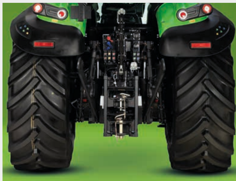
⬆ Enganche trasero, cinco distribuidores traseros, controles externos en los guardabarros.
