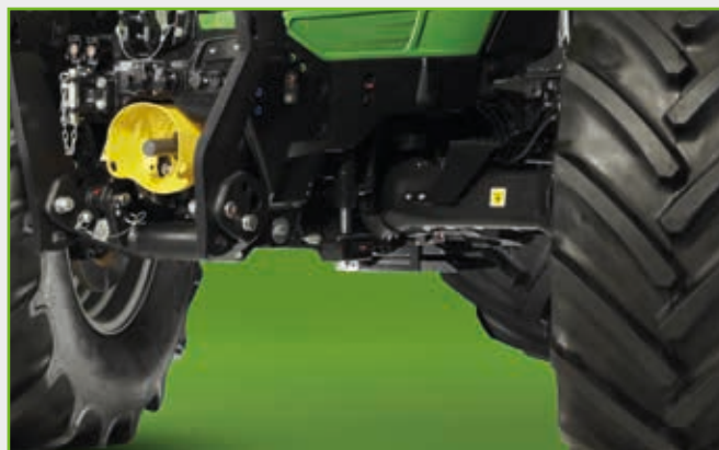
↑ Concepto de suspensión delantera con gran despeje y tres niveles de regulación en el InfoCenter PRO .
