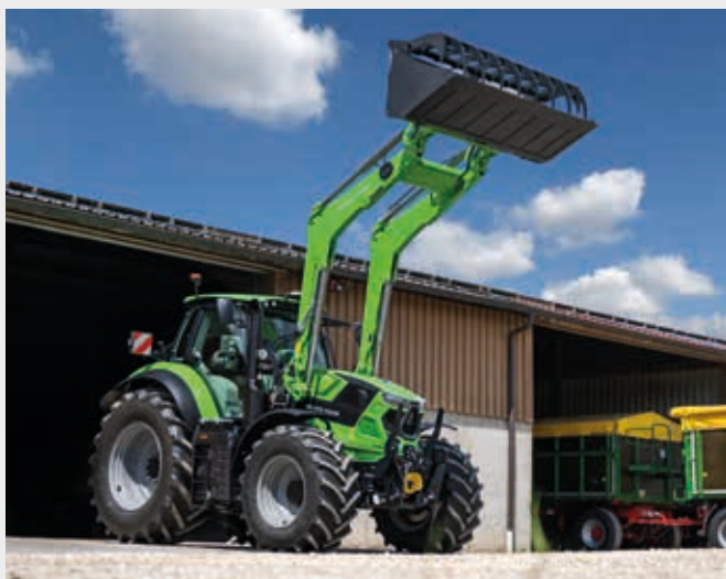
↑ Altura máxima de elevación de 4,5 m y fuerza de arranque de 3.770 daN.
