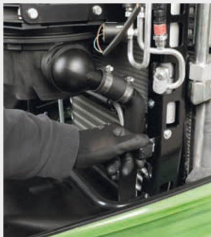
↑ Paquete de refrigeración con mecanismo de apertura fácil.
