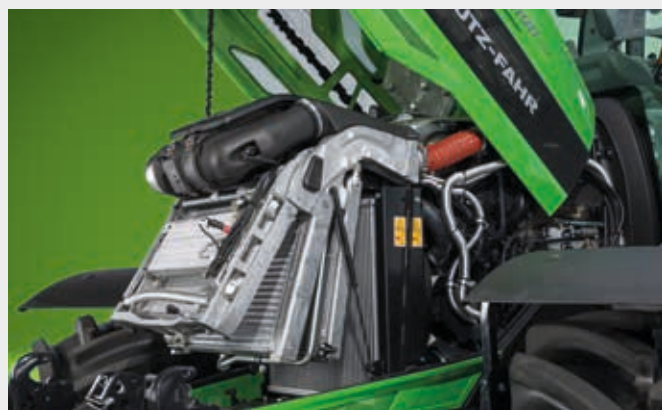
↑ Sistema de refrigeración en aluminio con palanca de acceso, accionable con una mano, y filtro de aire Powercore en el 6190 TTV.
