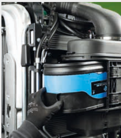
↑ Filtro de aire con unidad de prelimpieza.
