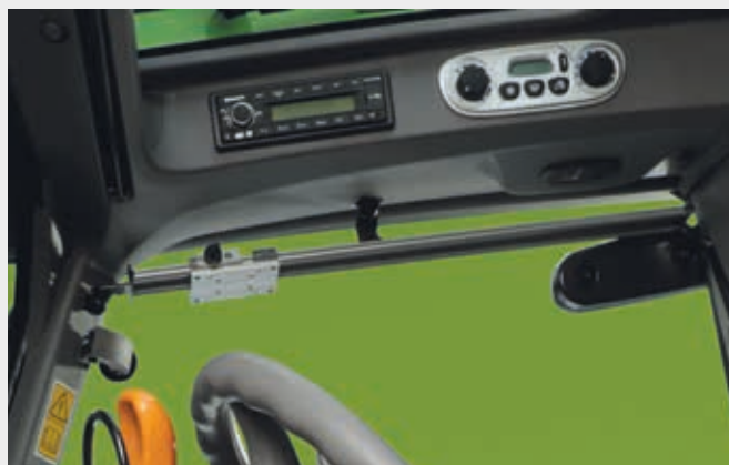
📌 Interfaces de control de la radio, del climatizador y las luces, así como un soporte para terminales adicionales.
