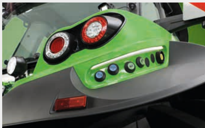
⬆ Pulsadores iluminados para controlar externamente el elevador trasero, la toma de fuerza y un distribuidor.
