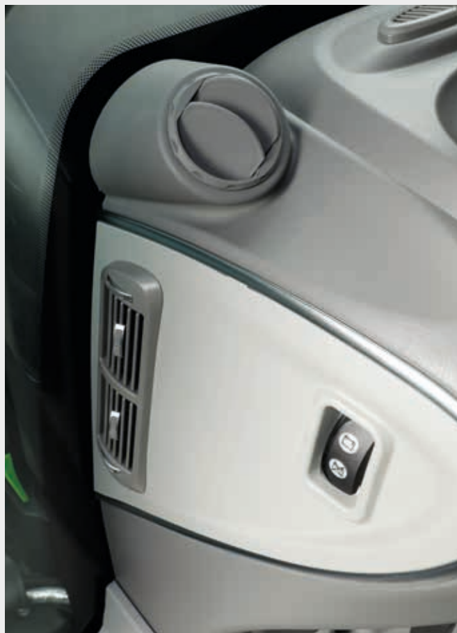
📌 Nuevas salidas de aire ajustables e interruptor de la batería situado a la izquierda de la columna de dirección, en una posición muy práctica.
