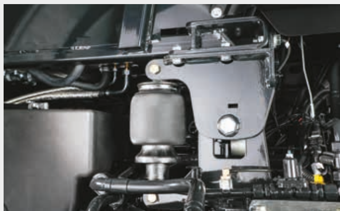
↑ Elementos de la suspensión neumática de la cabina.
