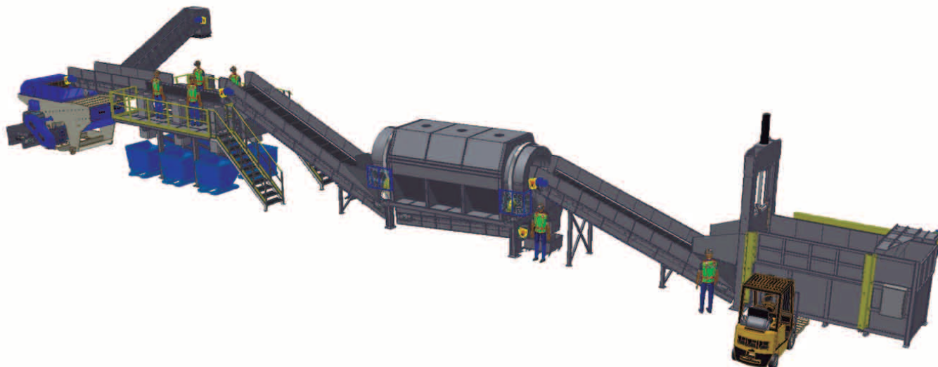
Instalación estándar para una producción (film agrícola) de 1200 k/h.
