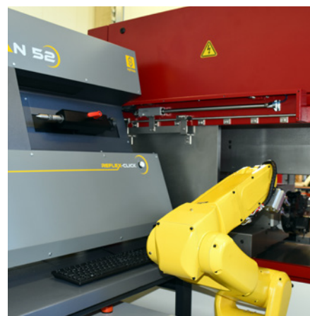
SCAN 52 y robot: lazo cerrado con corrección automática de la pieza
