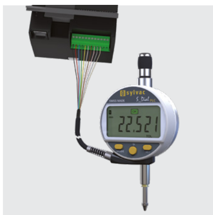
S_Dial WORK PLC conectado a un PLC
