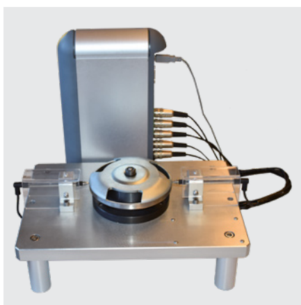
Palpadores capacitivos conectados a un D200S
