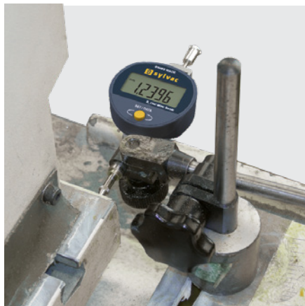
Medición del desplazamiento vertical de un elemento
