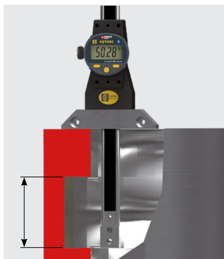
Medición de ranura interior (altura) por medio de la constante (Referencia automática)
