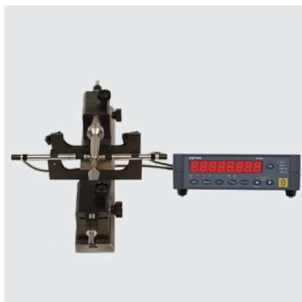
Midiendo un eje con 2 palpadores (A+B)
