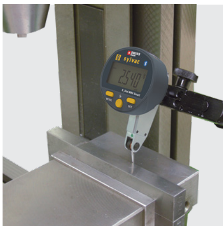
Verificación de planitud en una fresadora
