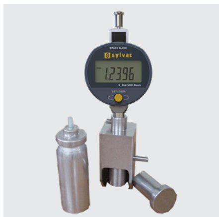
Verificación de interior \varnothing con dispositivo mecánico
