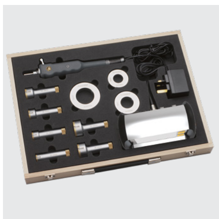
Juego que incluye 6 juegos de cabezas, 3 anillos patron, 1 D62S, el mango y su sonda, el cargador.
