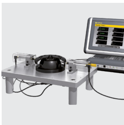
Sistema multicota conectado a interface D200S y display D300S
