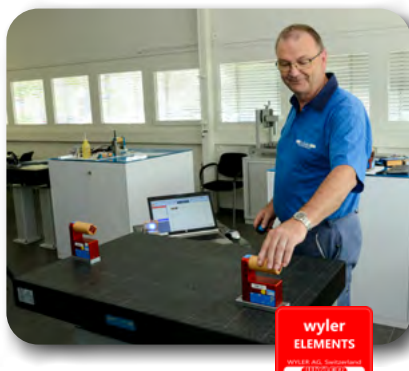
MEASUREMENT OF FLATNESS VERMESSUNG VON EBENHEITEN
