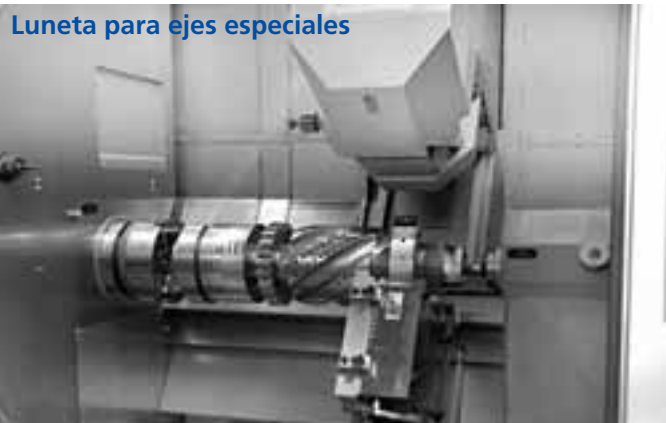
Luneta con patines de PCD para torneado en duro/rectificado de ejes primarios
