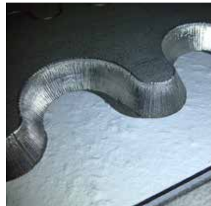
12 mm de espesor en acero inoxidable con 30° de bisel 12 mm Stainless Steel contour with 30° bevel
